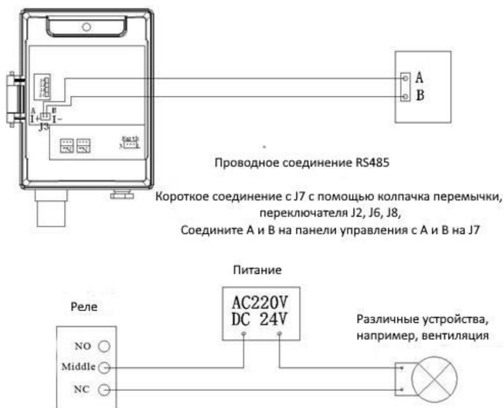
Рис. 3-2 Проводное соединение RS485
