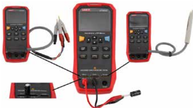
Рисунок 3-1. Тестирование электронных компонентов
